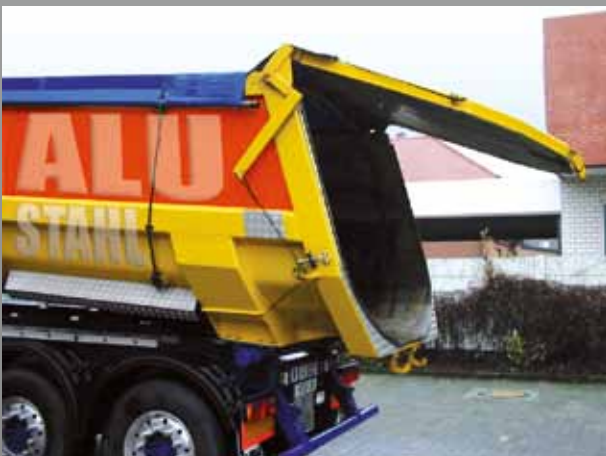
Rückwand mit pneumatischer Öffnung über Seilzug
