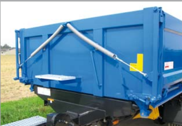
Federunterstützung für klappbar Bordwände
