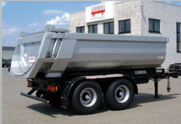
Hardox-Halbschalenmulde m. hydr. Rückwand
