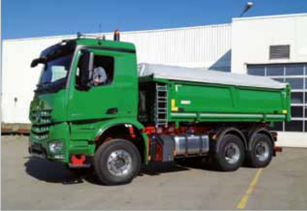
3-Seiten-Kippaufbau in gesickter Bauweise
