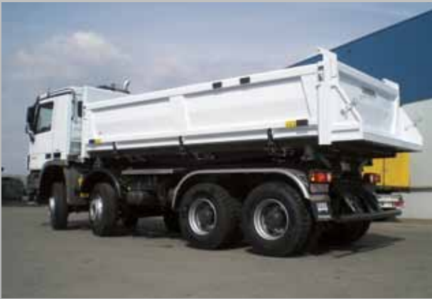
3-Seiten-Kippaufbau mit Bordmatik
