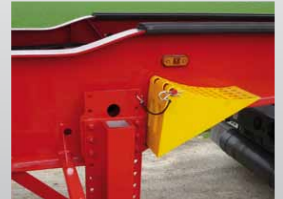
Gekröpftes Chassis zur Reduzierung der Gesamthöhe
