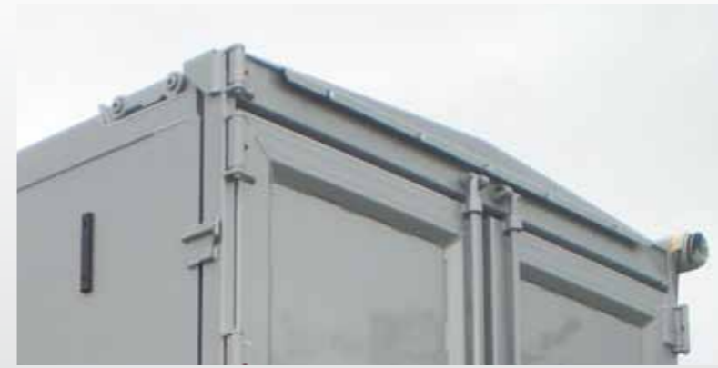
Flügel Tür mit Pendelrahmen (Visier)
