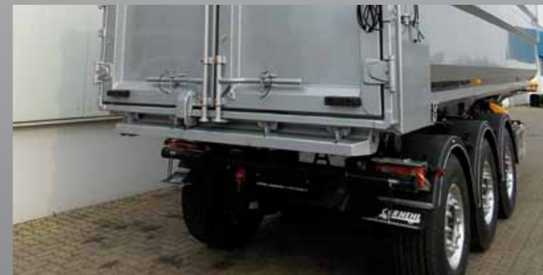
Hardox-Großraum: Flügel Türen mit Visier (4-fach Verriegelung)
