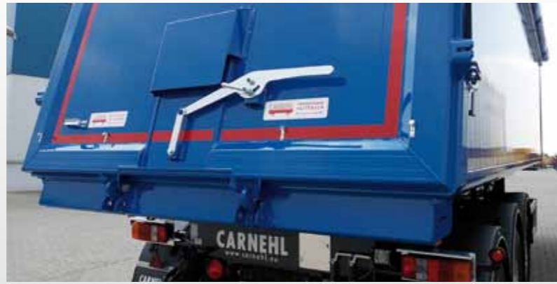
Rückwand mit Getreideschieber (2-fach Verriegelung)
