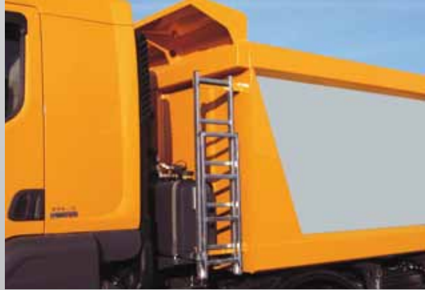
Schutzdach und klappbare Aufstiegsleiter
