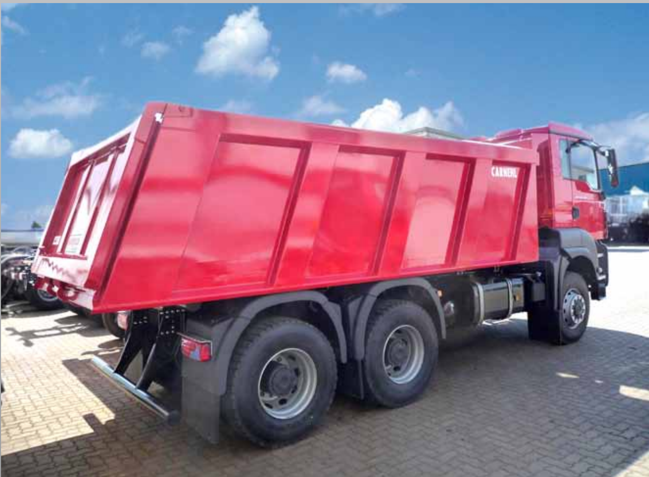
Hardox-Kastenmulde in Spantenbauweise
