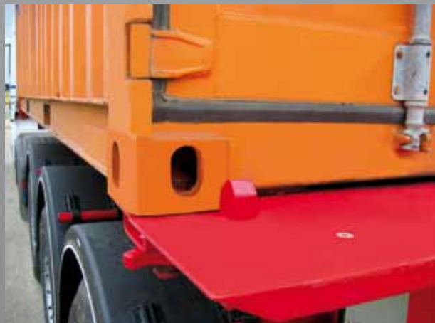
Schüttblech mit integrierter Containersicherung
