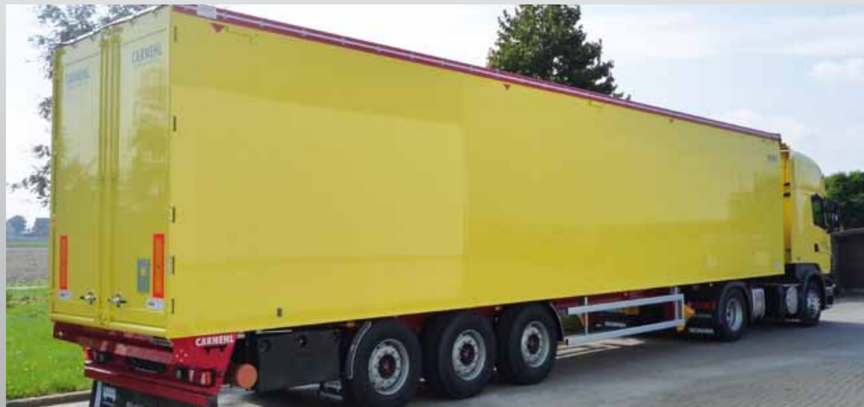
Klappbarer Seitenanfahrerschutz mit Alu-Leiter
