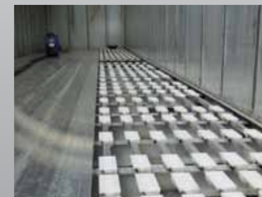
Bodengruppe durchgehend längsverstärkt
