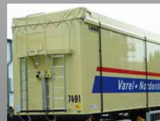
Podest mit beidseitigem Aufstieg
