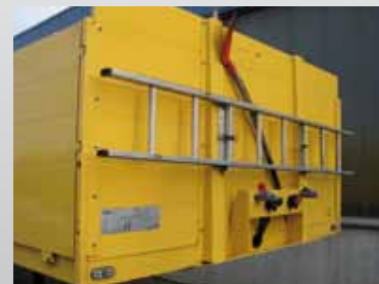
Leichte Stirnwand aus Aluminium
