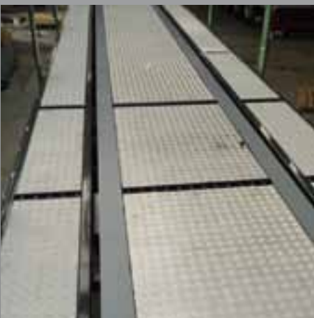
Spezieller rutschhemmender Aluboden für erhöhte Bodenreibungswerte
